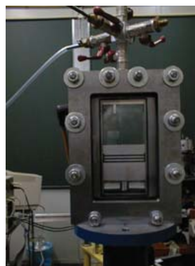
Rys. 5. Widok komory spalania maszyny pojedynczego sprężu
